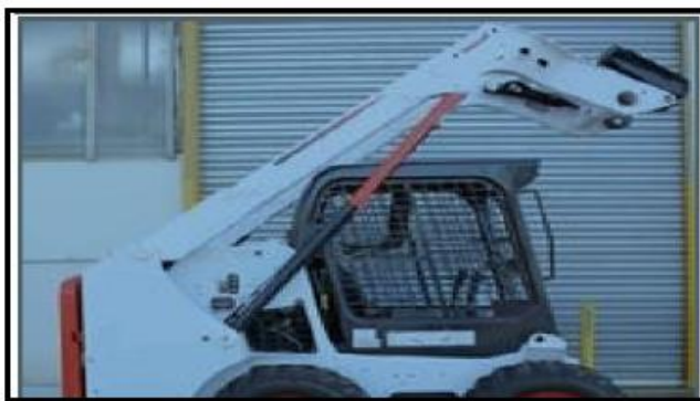
Photo 1 : Bobcat avec le godet en position haute - remarque: le système de sécurité (barre de verrouillage orange) est engagé
