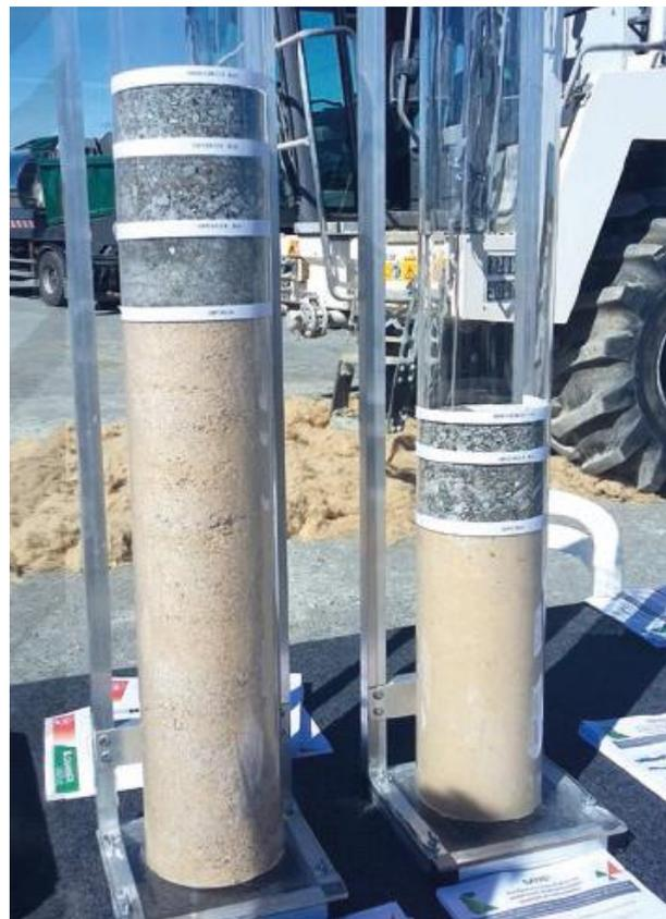
**Epaisseurs d'une structure de chaussée avec couche de forme en sable non traité (à gauche) et en sable traité (à droite)**
