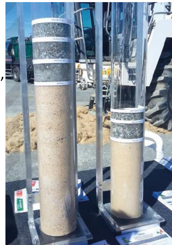
Épaisseurs couche de forme : - GNT = 0,50 m (à gauche) - Sol traité = 0,35 m (à droite)
