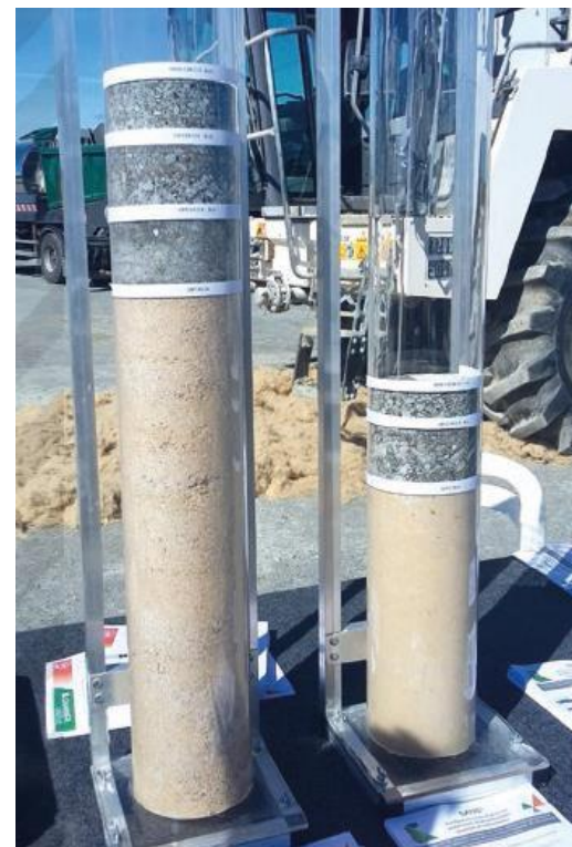
Epaisseurs couche de forme : - GNT = 0,50 m (à gauche) - Sol traité = 0,35 m (à droite)
