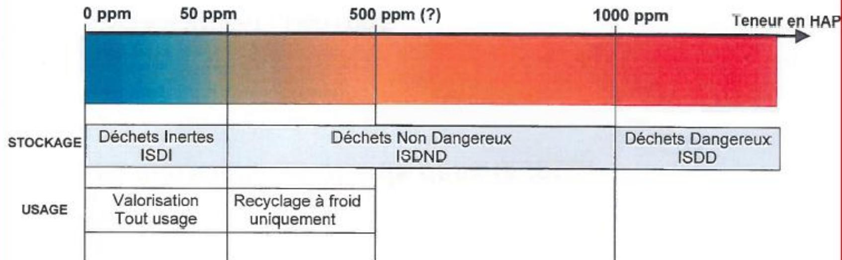
*Seuil de 500 ppm en HAP = limite du recyclage à froid : sans réchauffage ni chauffage des agrégats d'enrobés*
