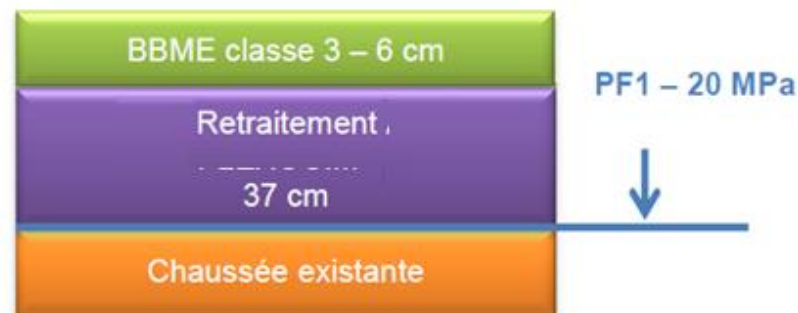
Structure RD 748 La Chapelle St Laurent
