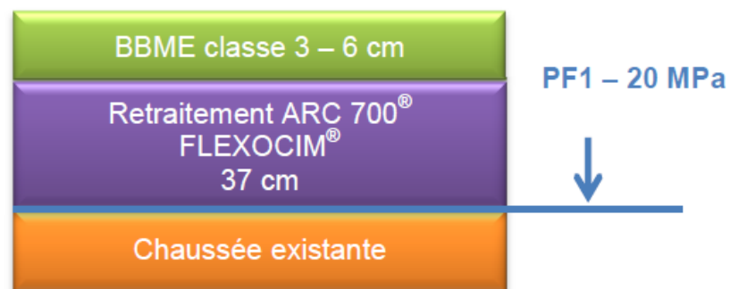
Structure RD 748 La Chapelle St Laurent
