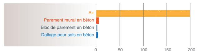
Comparaison des concentrations d'acétaldéhyde émises par trois parements en béton avec le seuil à ne pas dépasser pour prétendre au A+ sur l'étiquette « Émissions dans l'air intérieur » à 28 jours, en microgrammes par m<sup>3</sup>.
