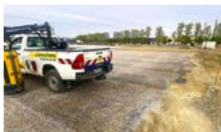
↑ Contrôle à la dynaplaque de la portance de la CDF traitée. ©Medinger & Fils
