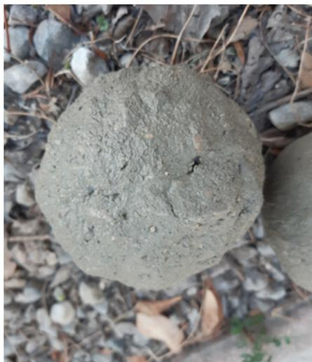
▲ La consistance optimale du BCR, succès de « l'essai à la boule » pour un BCR poreux (©Cimbéton) et pour un BCR de surface (©Colas).
