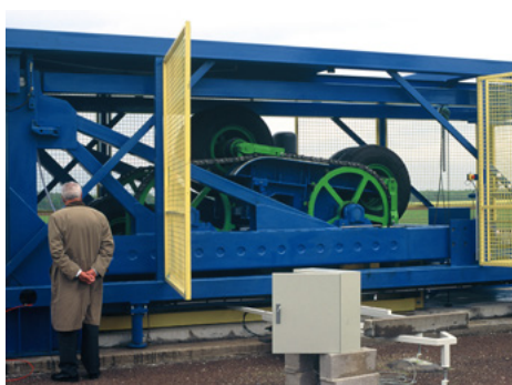
⬆ La Machine FABAC peut simuler le trafic en accéléré.
