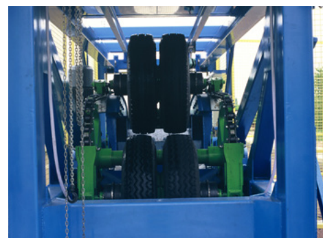
⬆ La Machine FABAC : 3 Essieux Standards en rotation qui simule un passage chaque seconde.
