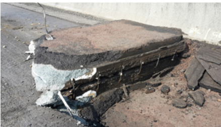
↗ Illustrations du collage entre le béton et la grave-bitume après 15 ans.
