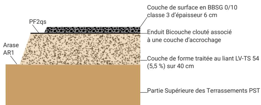
➤ Figure 5. Coupe en travers-type de la structure de chaussée pour les zones de circulation et de stationnement des poids lourds.
