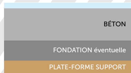
▲ Figure 1. Coupe en travers-type d'une structure de voirie ou d'un aménagement urbain en béton.
