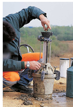
Vérification de la teneur en air occlus.
