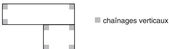
Des recouvrements des chaînages horizontaux entre eux et avec les chaînages verticaux sont impératifs (recouvrement des armatures par des barres en équerre).
