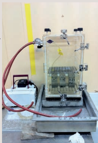
→ Porosité à l'eau. Matériel du DL Autun.
