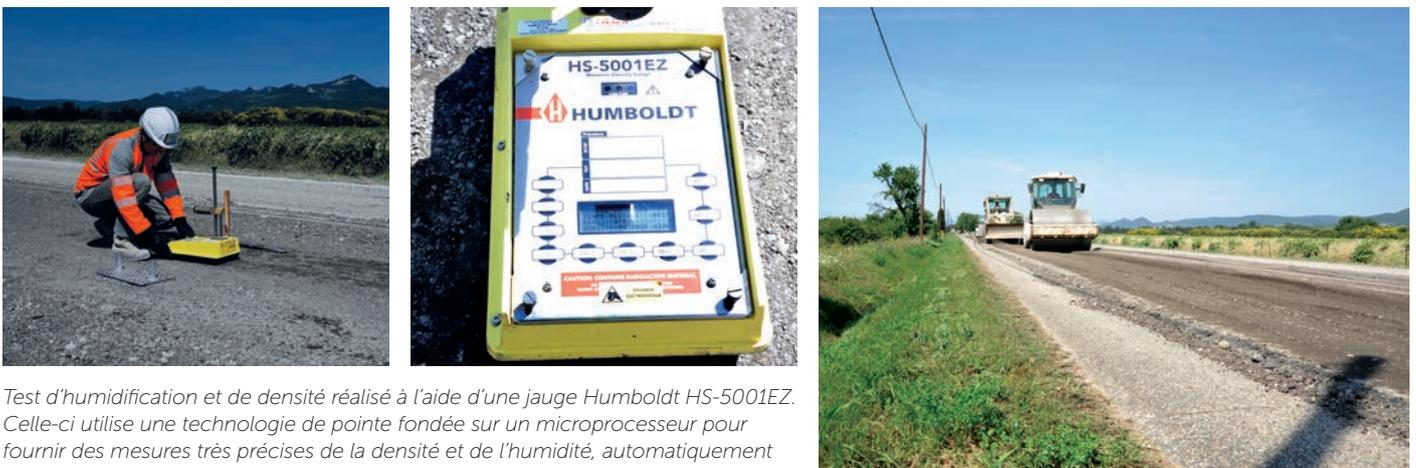
Test d'humidification et de densité réalisé à l'aide d'une jauge Humboldt HS-5001EZ. Celle-ci utilise une technologie de pointe fondée sur un microprocesseur pour fournir des mesures très précises de la densité et de l'humidité, automatiquement calculées. Cela permet la lecture directe de la densité humide, de la densité sèche, de la teneur en humidité, du pourcentage d'humidité, du pourcentage de compactage (Proctor).
