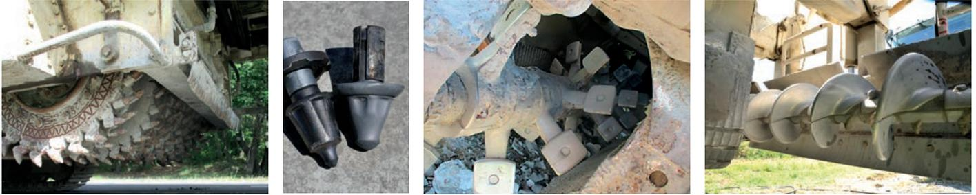
Les différents dispositifs (rotor vertical équipé de 224 dents, malaxeur longitudinal et vis de répartition transversale) qui permettent à l'ARC 1000 de réaliser « une parfaite homogénéisation verticale et transversale de la couche retraitée ».
