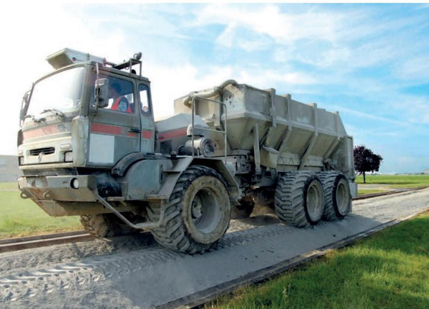
L'épandeur distribue avec précision le liant hydraulique.
