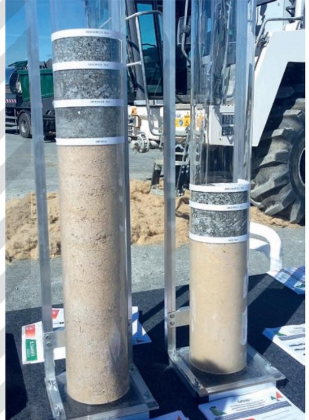
Photo illustrant le gain de matériau et l'économie de ressources naturelles que la structure innovante a engendrés (à gauche, structure traditionnelle avec couche de forme non traitée ; à droite, structure innovante avec couche de forme traitée).
