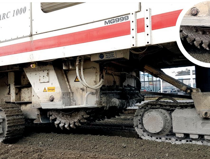
En plus de son rotor de 2 m de largeur avec 224 dents, l'ARC 1000® est équipé d'une lame flottante pour assurer le nivellement du fond de forme, d'un malaxeur, d'une vis de répartition et d'une lame de répandage. Outre la précision des dosages, l'homogénéité transversale et verticale du traitement est assurée par un malaxeur de centrale puissant.
