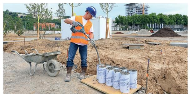
Préparation des tests de performances mécaniques et de tenue dans le temps.
