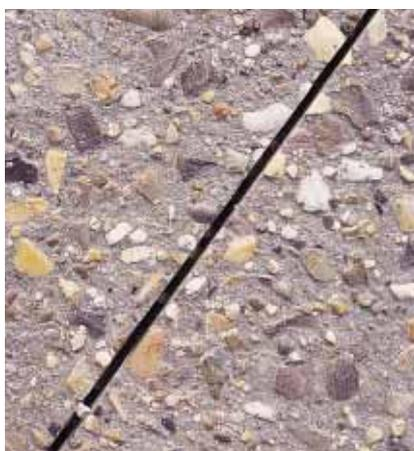
▲ Le choix d'un granulat silico-calcaire favorise l'intégration du béton au site.
