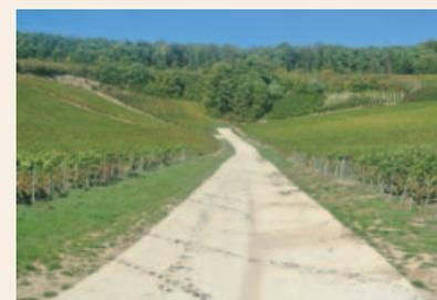
// En 2013 et 2014, Pass a réalisé 3,5 km de voirie en béton fibré balayé dans ce vignoble.
