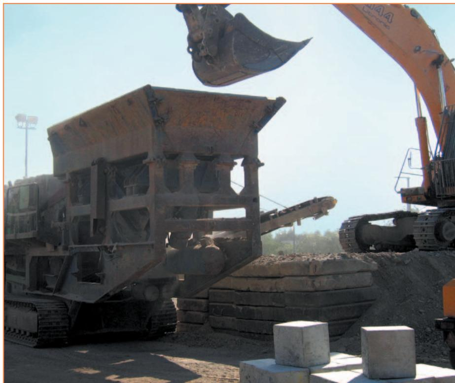
35 m<sup>3</sup> de bétons de première génération (coulés à l'Ifsttar sous forme de cubes de 40 cm d'arête) ont été concassés en trois classes granulaires sur une plateforme industrielle de recyclage à Nantes.
