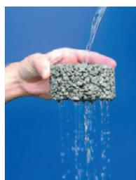
Le béton prêt à l'emploi drainant est dit « à structure ouverte » car il possède un pourcentage élevé de vides (dus à sa faible teneur en sable) qui permet à l'eau de le traverser aisément.
