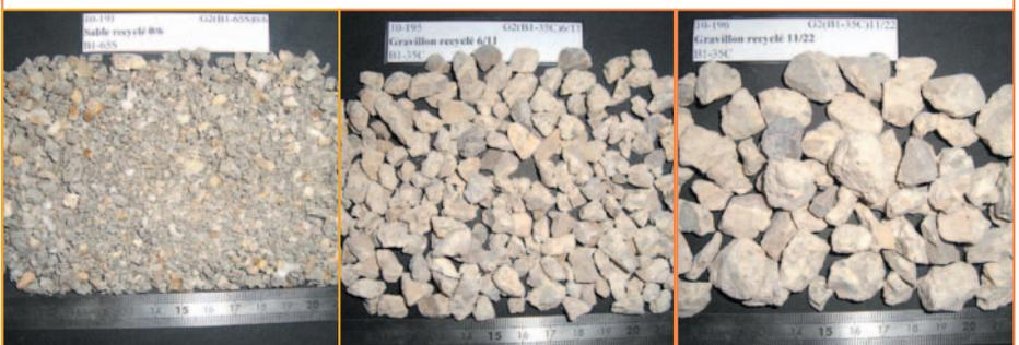
Dans le cadre de la thèse de Duc-Tung Dao, les bétons de première génération (après trois mois de durcissement) ont été concassés et criblés en trois classes granulaires : 0/6,3 mm (à gauche), 6,3/11,2 mm (au centre) et 11,2/22,4 mm (à droite).
