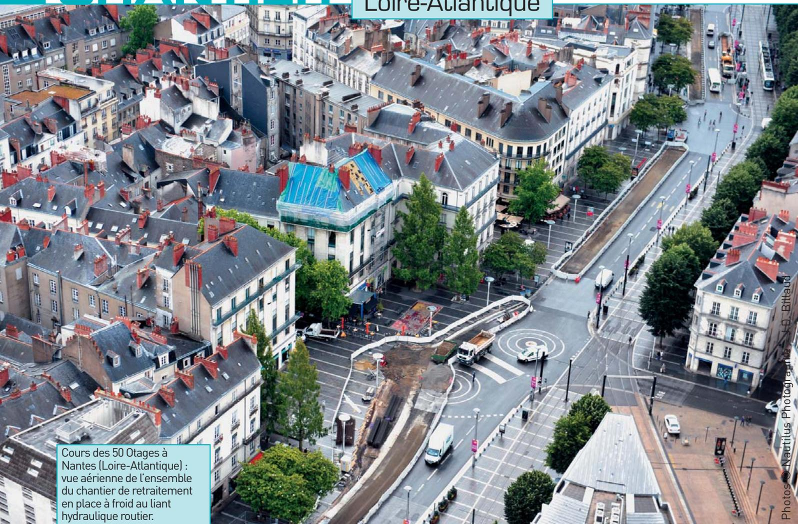
Cours des 50 Otages à Nantes (Loire-Atlantique) : vue aérienne de l'ensemble du chantier de retraitement en place à froid au liant hydraulique routier.
