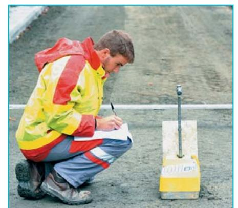
La mesure de densité sert à vérifier le bon compactage nécessaire à l'obtention de performances mécaniques élevées.
