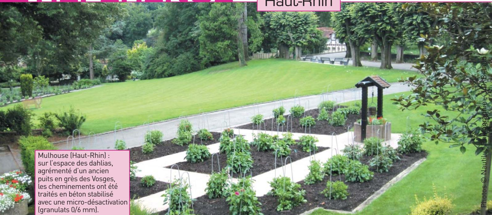
Mulhouse (Haut-Rhin) : sur l'espace des dahlias, agrémenté d'un ancien puits en grès des Vosges, les cheminements ont été traités en béton stabilisé avec une micro-désactivation (granulats 0/6 mm).
