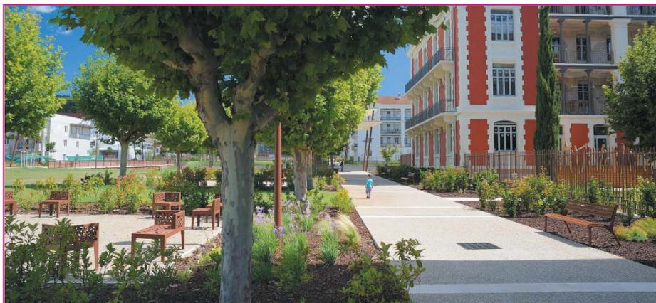
Longeant les anciens bâtiments militaires, l'allée rectiligne en béton désactivé est interrompue par des bandes structurantes en pierres calcaires.
