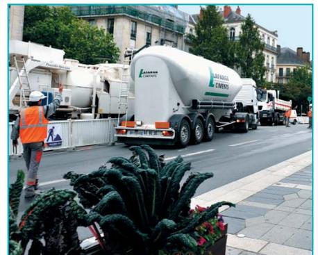
La livraison « juste à temps » du liant hydraulique est faite par camion-citerne de 25 tonnes en centre-ville, pour éviter toute rupture d'approvisionnement.
