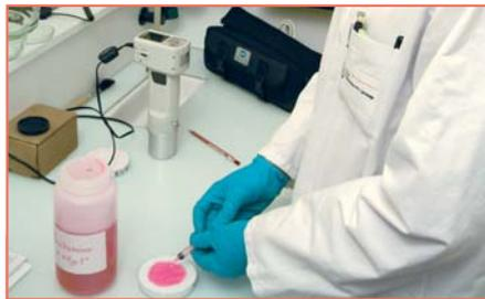
Essais de pigmentation des bétons, avant passage sous la lampe UV.
