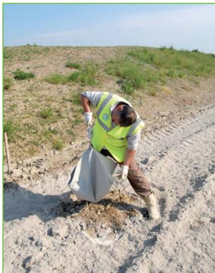
Un technicien vérifie par pesée le dosage exact en liant hydraulique routier (essai dit "à la bêche").
