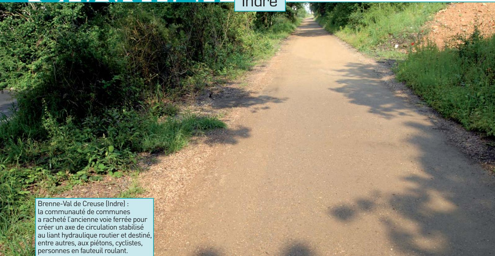
Brenne-Val de Creuse (Indre) : la communauté de communes a racheté l'ancienne voie ferrée pour créer un axe de circulation stabilisé au liant hydraulique routier et destiné, entre autres, aux piétons, cyclistes, personnes en fauteuil roulant.
