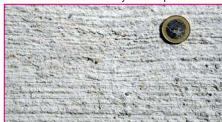
Le béton de roulement balayé, réalisé avec des granulats 2/10.
