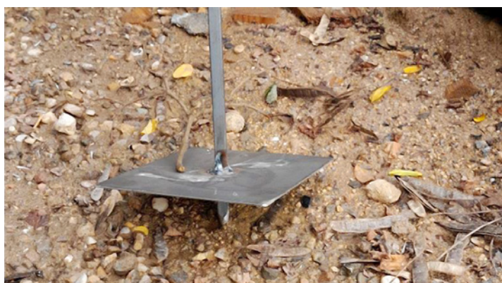
Figure 17 : photos illustrant l'un des moyens de contrôle de l'épaisseur de la couche BFUP.
