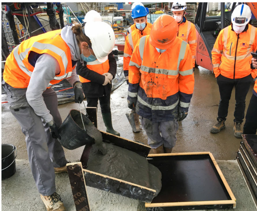
Figure 18 : exemple d'une façon correcte de déverser le BFUP dans les moules pour les essais de plaques minces.
