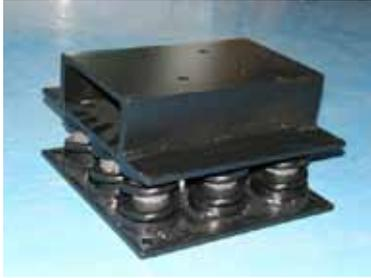
C'est une solution standard en acoustique industrielle: utiliser des plots de découplage ou plots antivibratoires. Ils sont soit de type élastique (en caoutchouc) soit à ressorts (métalliques). Ces plots sont testés pour une dureté et une gamme de fréquences de résonance.
