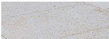
**Le béton bouchardé** a subi, après durcissement, un traitement mécanique par martelage à l'aide d'un outil à pointes appelé boucharde.
