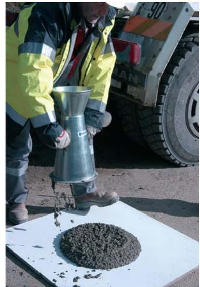
De ce fait, **les rajouts d'eau sont interdits** car ils diminuent significativement les performances mécaniques des bétons, ainsi que leur compacité, et augmentent les risques de ségrégation et de fissuration.
