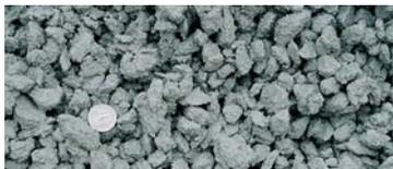
**Le béton drainant** s'obtient par utilisation de granulats d'une taille étudiée pour assurer sa porosité, ce qui draine les eaux de pluie et le rend, de ce fait, antidérapant.
