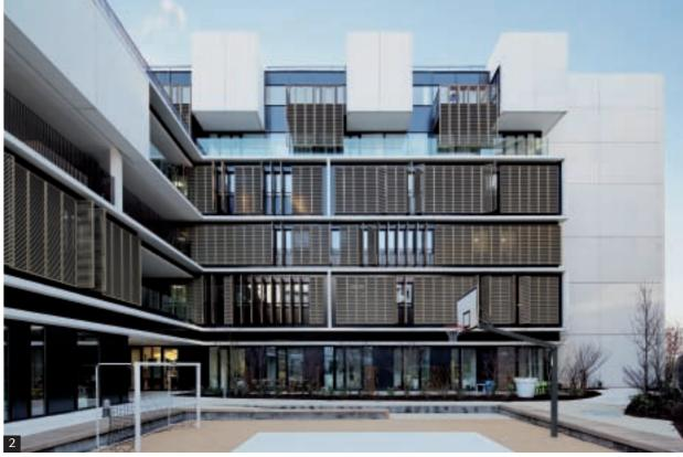
→ 1 • Des persiennes disposées entre les nez de plancher en béton blanc protègent les espaces intérieurs. 2 • La figure en L du bâtiment permet un ensoleillement maximum.
