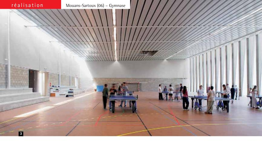
3 Gradins en béton préfabriqué, revêtement intérieur en blocs béton: l'intérieur du gymnase est caractérisé par la volonté de décliner le matériau béton. Les 80 cm de profondeur des piles permettent de diffuser la moindre variation de lumière extérieure et créent une atmosphère intérieure à la fois douce et sereine.
