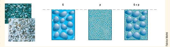
>>> Empilement granulaire. Un mélange optimal des grains constitutifs du béton permet d'obtenir une porosité minimale du squelette granulaire, sur la base, généralement, de quatre tailles de grains pour une compacité maximale. L'ajout de particules ultrafines (fumées de silice, par exemple) accroît encore la compacité du mélange.
