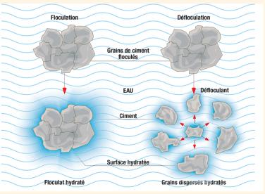
>>> Principe de défloculation: en s'opposant à la floculation (agglomération) des grains de ciment, les superplastifiants améliorent l'hydratation du matériau et réduisent ainsi les besoins en eau de gâchage.
