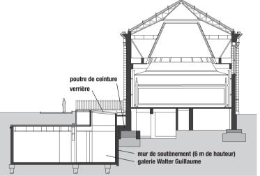
>>> Coupe transversale. Les bétons apparents sont des bétons autoplaçants (BAP) prêts à l'emploi. Utilisés en reprise en sous-œuvre des ouvrages existants, ils ont permis de couler en place sans vibration la poutre de ceinture du bâtiment et le mur de soutènement de grande hauteur, qui restent apparents dans la galerie des Impressionnistes de la collection Walter Guillaume, au sous-sol.
