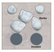
>>> Phénomène de blocage des granulats. Sans précaution ni formulation particulière, les granulats ont tendance à se bloquer au voisinage des armatures.
