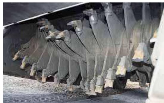
▲ L'organe principal est un rotor de 2,50 m de large, équipé de dents en alliage spécial, qui s'enfoncent à 40 cm de profondeur.
