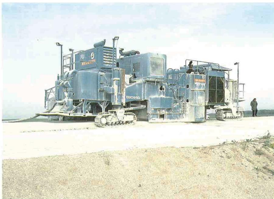
▲ La deuxième machine décohesionne le support, malaxe et intègre 6 % de ciment et 20 % d'eau sur 35 cm d'épaisseur.
