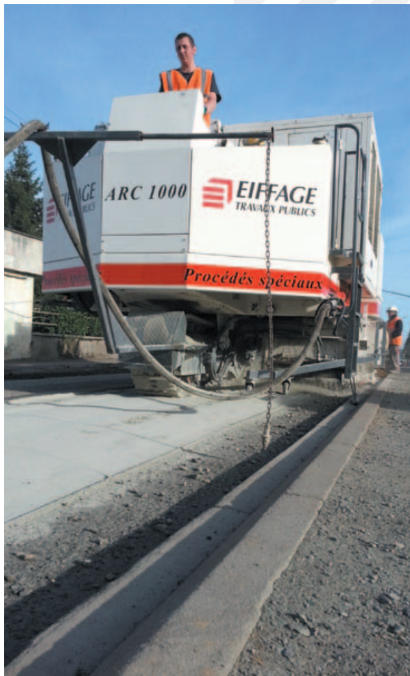
L'ARC® 1000 vu de face, avec sa chenille avant qui précède le rotor de 2 mètres de largeur doté de 224 dents.
