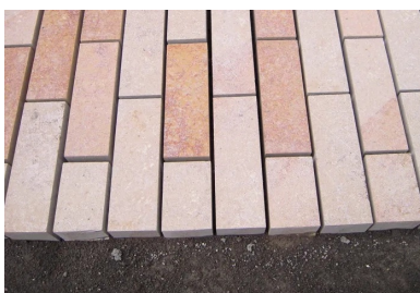
Le Buxy est une roche sédimentaire compacte. C'est un calcaire à grains fins et serrés et à petits cristaux de calcite, de couleur jaune-roux. Cette pierre naturelle peut présenter des taches ovalées et des zones flammées ou veinées de couleur lie-de-vin à mauve ou grise. Le Buxy est une pierre très dure, apte au grand trafic. Cette pierre peut être flammée pour obtenir une surface rugueuse antidérapante. Le Buxy est une pierre non gélive.
