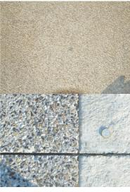
Les deux formules mises en œuvre sur le site Socara. Une formule qualitative en 100 % ciment blanc (avec un mélange de gravillons de Sault-Brénaz 4/6 à 50 % et de Roussas 4/6 à 50 %).
