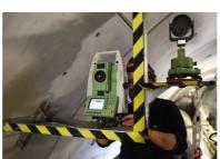
Le tracé est enregistré en machine et un contrôle permanent par théodolite est e ectué lors du creusement. Le géomètre donne les instructions au pilote, anneau par anneau, pour suivre la honne direction.
