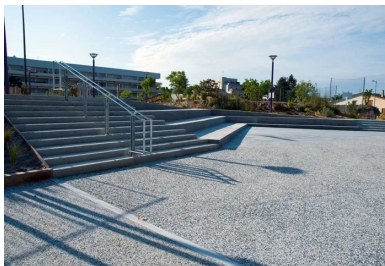
Les nez de marche et les contremarches des escaliers sont en béton hydrosablé
