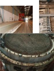
Figure 12 : exécution des planchers par une machine à coffrage glissant (extrusion) et vue des ancrages de torons aux extrémités du banc.
