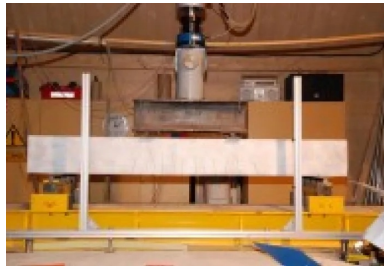
Figure 10. Fissures visibles repérées au feutre sur une poutre en BHP soumise à un essai de flexion pour un chargement de 30% de sa rupture.
