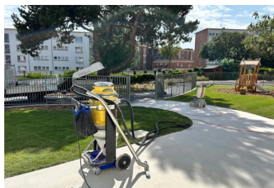
Aspirateur utilisé lors du ponçage du béton. © Efcat
