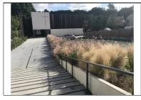
Béton drainant en aménagement désimperméabilisé à Montigny-lès-Cormeilles.
