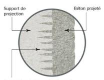
Incrustation de la couche d'accueil du béton projeté dans les pores du support
