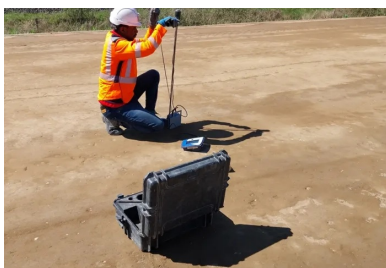
Contrôle de compactage au pénétromètre dynamique léger à énergie variable Panda. (©Joseph Abdo/JA-Consulting)
