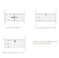
Pour les dallages soumis à un trafic extrême, au sens du 6.1.4 de la NF DTU13.3 P1·1-1, un dispositif assurant la continuité de roulement au droit des arrêts de coulage doit être prévu. Les arrêts de coulage, de types sinusoïdaux ou à peigne ou similaires, peuvent répondre à cette exigence :
