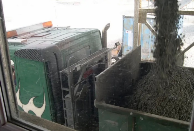
Le BCR peut être fabriqué dans une centrale continue de type grave traitée. (©Cimbéton)
