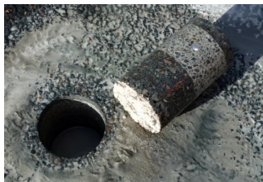
Illustrations du collage entre le béton et la grave-bitume après 15 ans.
