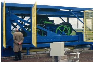
La Machine FABAC peut simuler le trafic en accéléré.
