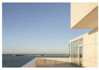
Le dessus des murs de terrasse intègre un léger creux dans le béton de manière à éviter l'ombre et le débord de la couvertine sur la façade.
