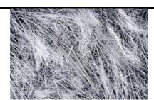
Les bétons fibrés : un vaste choix de solutions constructives Un béton fibré est un matériau composite associant une matrice (le béton) et un renfort (les fibres). Les fibres ont pour rôle principal...
