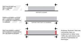
Lorsque, à un moment donné et à un endroit particulier, cette contrainte est supérieure à la résistance à la traction du béton, le revêtement en béton se fissure (Cf. Figure 3). En l'absence de dispositions constructives (Cf. Encart 2), le revêtement en béton fissure d'une facon aléatoire et incontrôlable.
