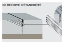
Figure 6. Schéma d'un joint de retrait moulé
