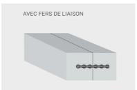
Figure 13. Joint de construction longitudinal avec fers de
