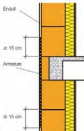
L'entoilage au niveau des coffres des volets roulant est également recommandé.
